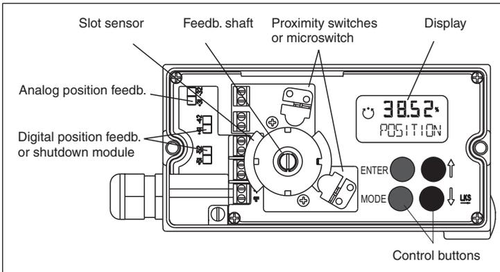
**Fig. 2 TZID-C positioner, open**
